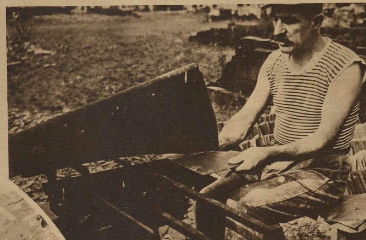
Operario francés recortando una teja de pizarra con una pesada hoja que se mueve por medio de un mecanismo de pedal. La hoja descende por su propio peso a hacer el corte.
