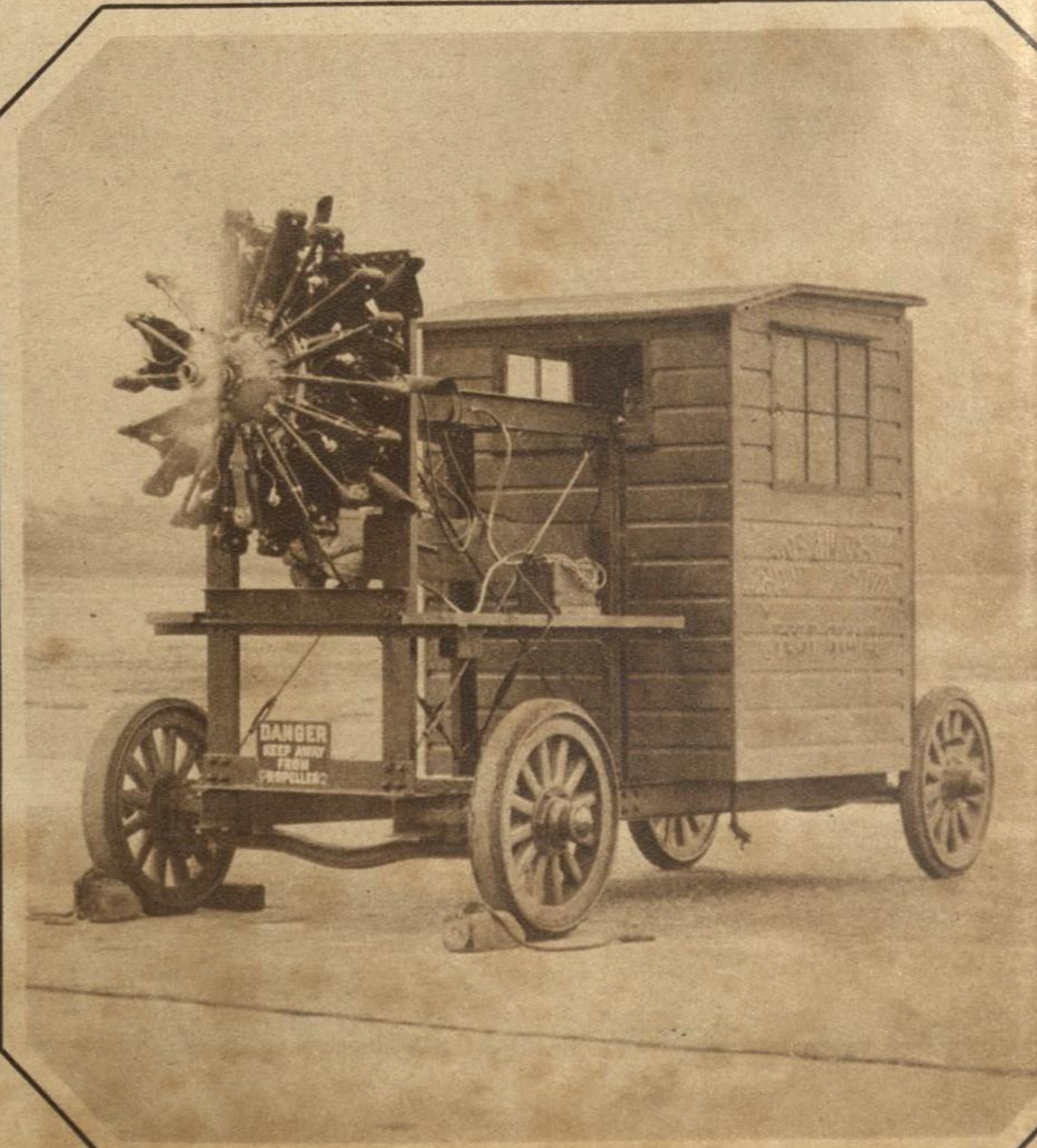
UN EDIFICIO AMBULANTE es esta estación para probar motores de aeroplanos, que se halla en servicio en Roosevelt Field, Nueva York.
