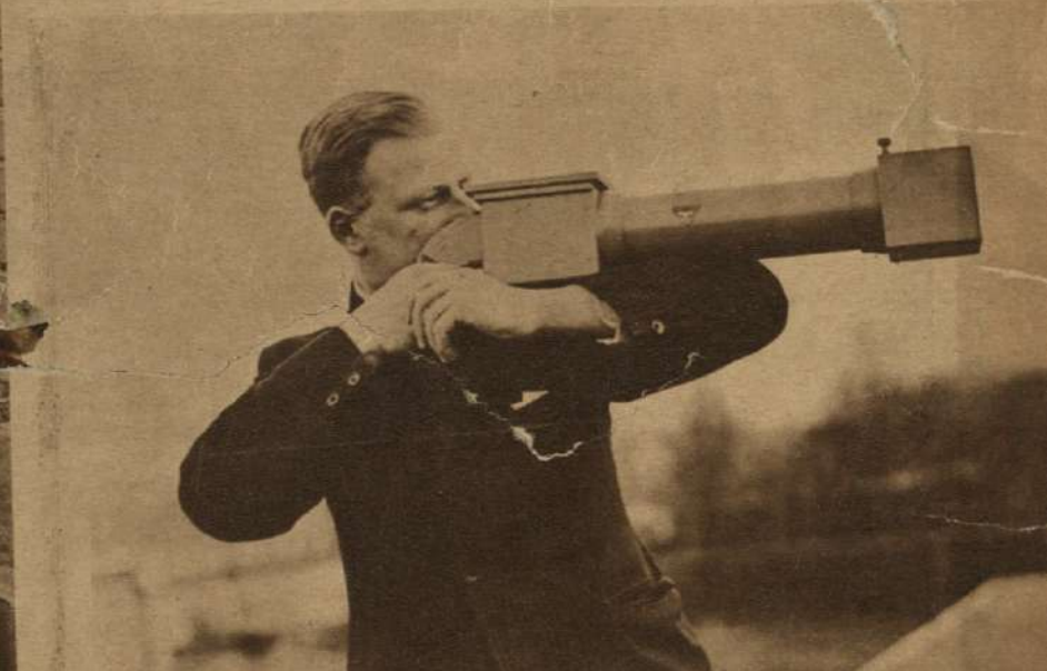
"Cañón de Señales" de "Luz Invisible" que puede hacer llegar un delgado rayo luminoso a 6 kilómetros, y el cual es sólo visible para quienes están a su paso.
