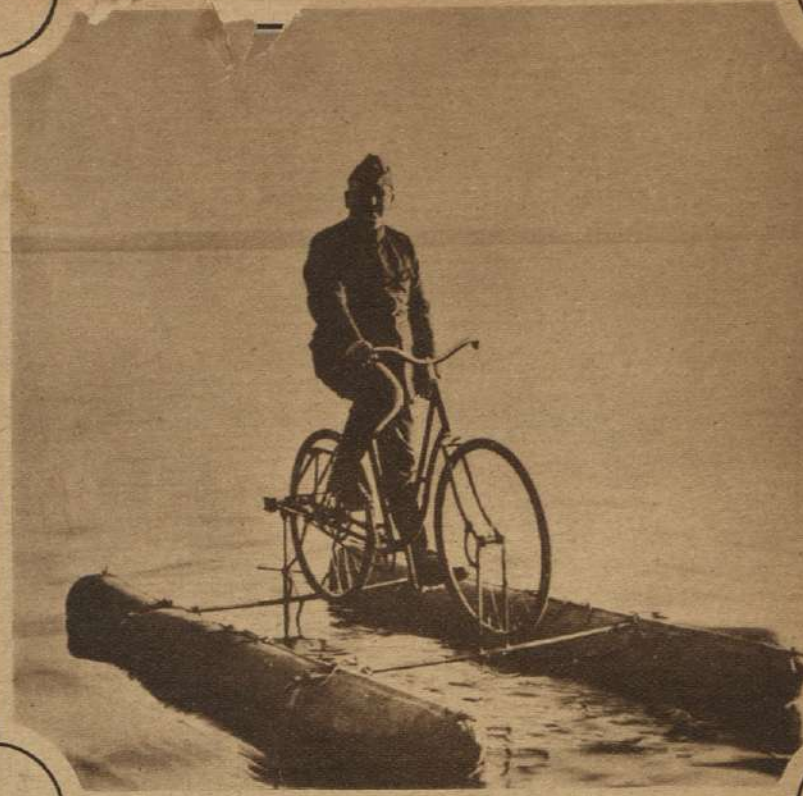
UNA BICICLETA ANFIBIA.—Alfred Kreutz, de Subba, Prusia Oriental, inventó esta ingeniosa combinación. En tres minutos, se transforma en bicicleta, y la adaptación de una hélice le permite navegar a una velocidad moderada.
