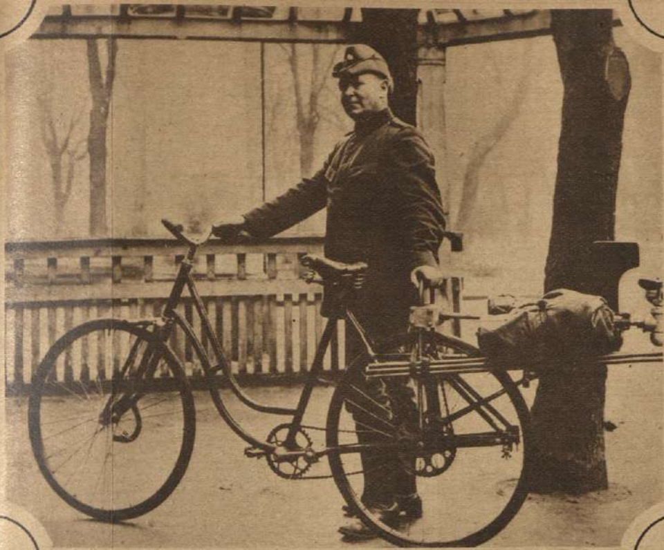
UNA BICICLETA ANFIBIA.—Alfred Kreutz, de Subba, Prusia Oriental, inventó esta ingeniosa combinación. En tres minutos, se transforma en bicicleta, y la adaptación de una hélice le permite navegar a una velocidad moderada.
