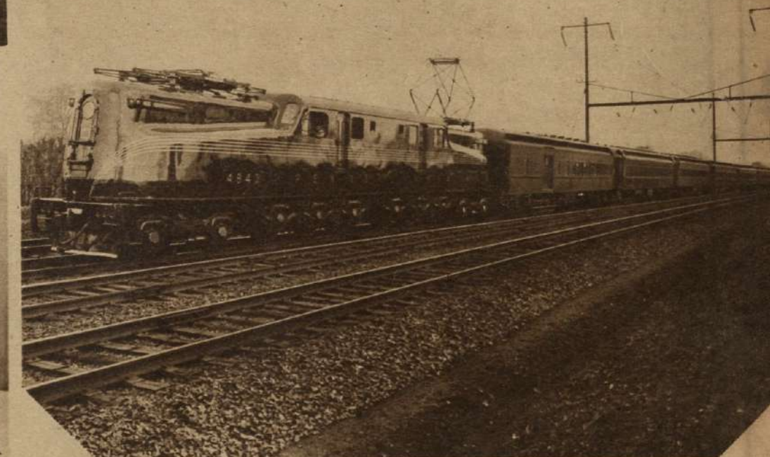
El sistema ferroviario Pennsylvania, de Estados Unidos, emplea 48 locomotoras eléctricas de este modelo, para el servicio entre Nueva York y Washington. Cada una pesa 220,000 kilogramos y mide 25 metros de largo, pudiendo jalar 17 carros dormitorios a una velocidad de 150 kilómetros por hora.
