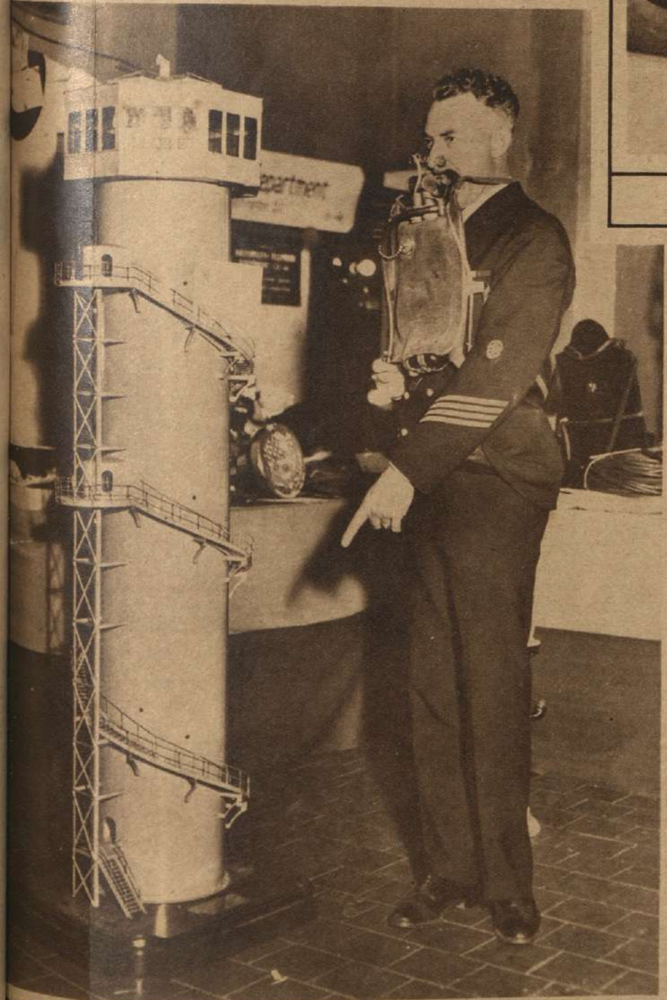
EL CURIOSO APARATO RESPIRATORIO que lleva el marino a la derecha, es el "pulmón artificial" adoptado para los submarinos ingleses, para permitir a los tripulantes de los sumergibles escapar en caso de emergencia. A la izquierda, un modelo de la torre de 50 metros de alto, llena de agua, en la cual los marinos se ejercitan como al uso del "pulmón artificial".
