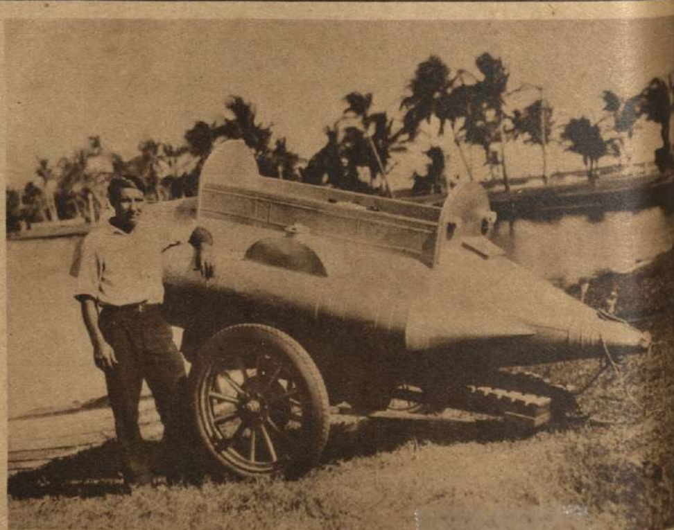
APARATO INSUMERGIBLE, inventado por Fred Ancidoni; su hélice es impulsada por pedales, como una bicicleta. Puede navegar a la velocidad de ocho kilómetros por hora.
